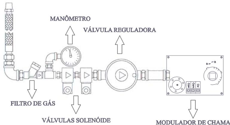
*Esta configuração exemplifica os componentes básicos do Qualy-Flow Master podendo variar de componentes em função da vazão e potência do queimador.*
