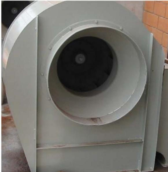
Neste tipo de flange existe a necessidade de fixar o duto do queimador com solda elétrica ou se o cliente preferir deve confeccionar um anel que será soldado no flange e então o nosso duto será fixado da maneira convencional, conforme descrito acima.
