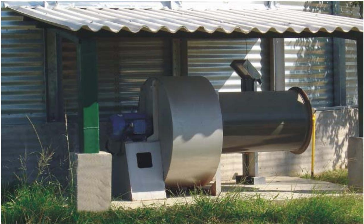
O Qualy Flow deve ser colocado sobre uma base de concreto para isto siga os seguintes passos:
