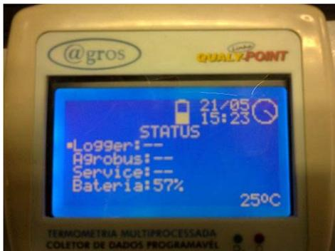
Exibe os status do sistema, logger, agrobus, service (não utilizado) e a bateria. O símbolo OK (visto) significa que o status está habilitado e operando corretamente. O símbolo ERR (xis) significa que o status está habilitado, porém com erro na operação.
